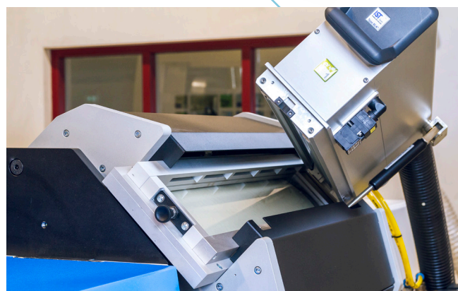
Inerte kamer met UV lamp voor curing
