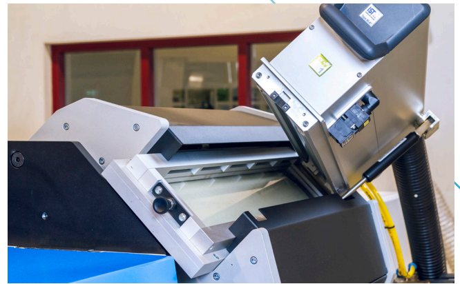
Inertkammer mit UV-Lampe zum Aushärten
