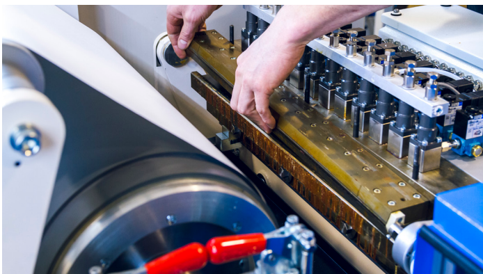
Wisselsysteem voor DieRect Roller Nozzle en SlotNozzle
