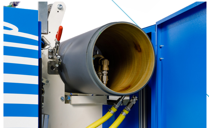
Sleevesysteem op coatingwals
