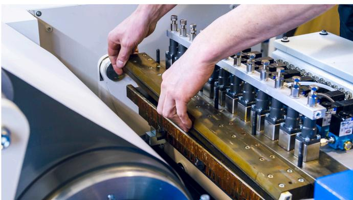
Wechselsystem für SlotNozzle und DieRect Nozzle
